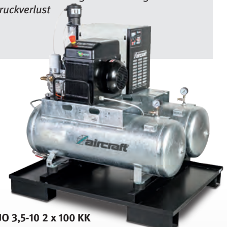
Ausstattung DUO KK zusätzlich mit: 1. Kondensataufbereiter zur Öl-Wasser-Trennung 2. Automatischer Kondensatableiter verbaut am Kondensatablass der Druckluftbehälter, Kondensatableitung ohne unnötigen Druckverlust
