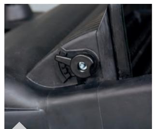
Einfache und werkzeuglose Höhenverstellung der Kehrwalze
