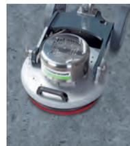
▶ Entwachsen und Aufpolieren von Vinylböden
