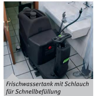
Frischwassertank mit Schlauch für Schnellbefüllung
