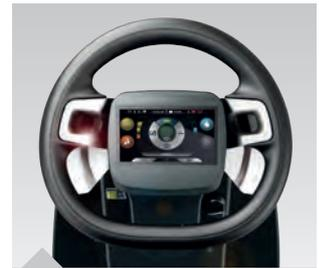
Lenkrad in der Ausführung „PLUS“ mit Touchscreen-Bedienfeld und Schaltwippen für Arbeitsdruck und Rückwärtsgang
