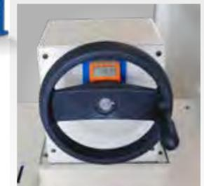
▶ Bedienung des Hinteranschlages von der Maschinenfront über Handrad und Zählwerk
