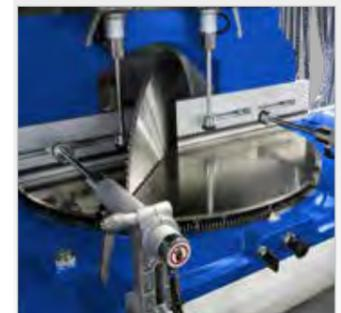
▶ Stufenlose Verstellung des Gehrungswinkels
