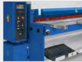
▶ *Bedienpult an der linken Maschinenseite*
