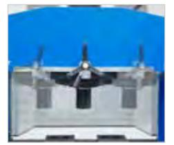
▶ Schnelle und einfache Verstellung des Zylinders über Zahnstange und Sterngriff
