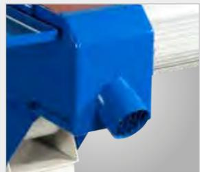
▶ Absaugstutzen-Ø 100 mm (Abb.: MBSM 150-200-2)
