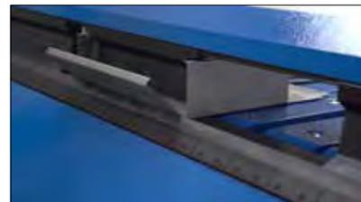
Sehr gut geeignet für die Herstellung von hohen Kästen mit 170 mm. Seitenhöhe und Materialstärken bis 4 mm – optional Seitenhöhen bis 200 mm möglich
