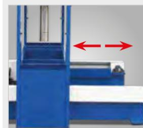
▶ Verfahrbarer Werkstücktisch zum einfachen Auflegen sperriger oder schwerer Werkstücke
