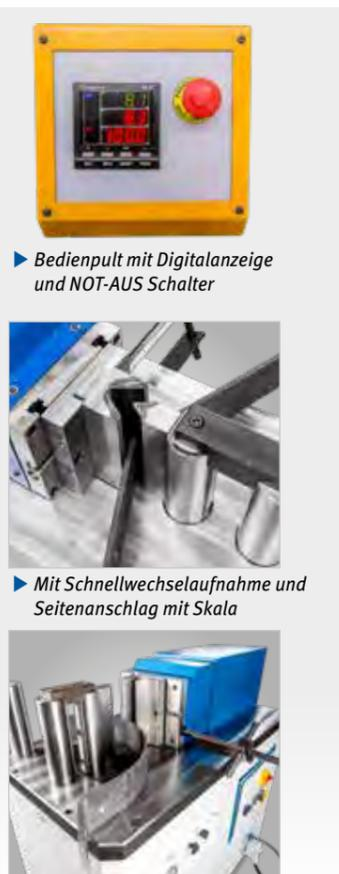
▶ Bedienpult mit Digitalanzeige und NOT-AUS-Schalter
