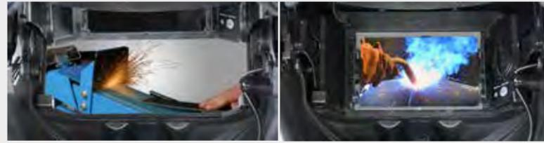
► **Flip-Up System:** Kassette wird im Helm hochgeklappt, um z. B. beim Schleifen direkt durch die klare Schutzscheibe schauen zu können
