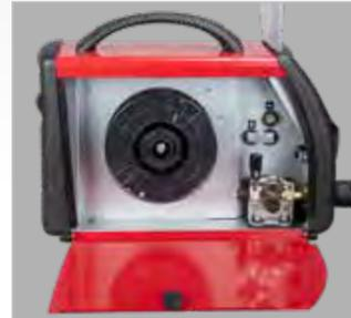
Im Innenraum umpolbar für Fülldrähte für 5kg Spule-Ø200
