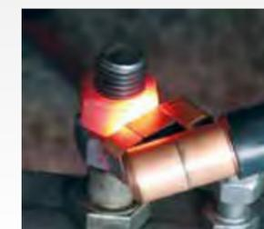
Erwärmen einer Mutter mit der Fokusspule schräg
