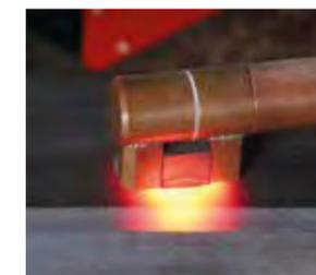
Erwärmen eines Bauteils mit der Fokusspule seitlich
